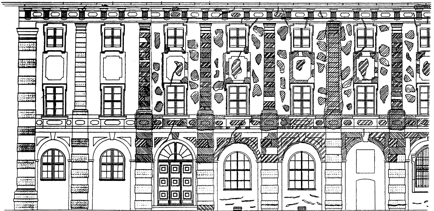
Kartierungsbeispiel für Putzschäden
