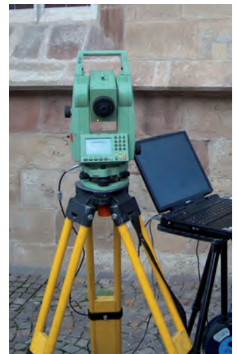
Abb. 8. Arbeit mit Tachymeter und Kartierung am Notebook.
